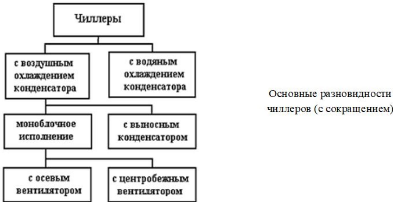
Чиллеры можно разделить на две группы: с воздушным охлаждением конденсатора и с водяным охлаждением конденсатора. В первую группу входят моноблоочные чиллеры и чиллеры с выносным конденсатором.
