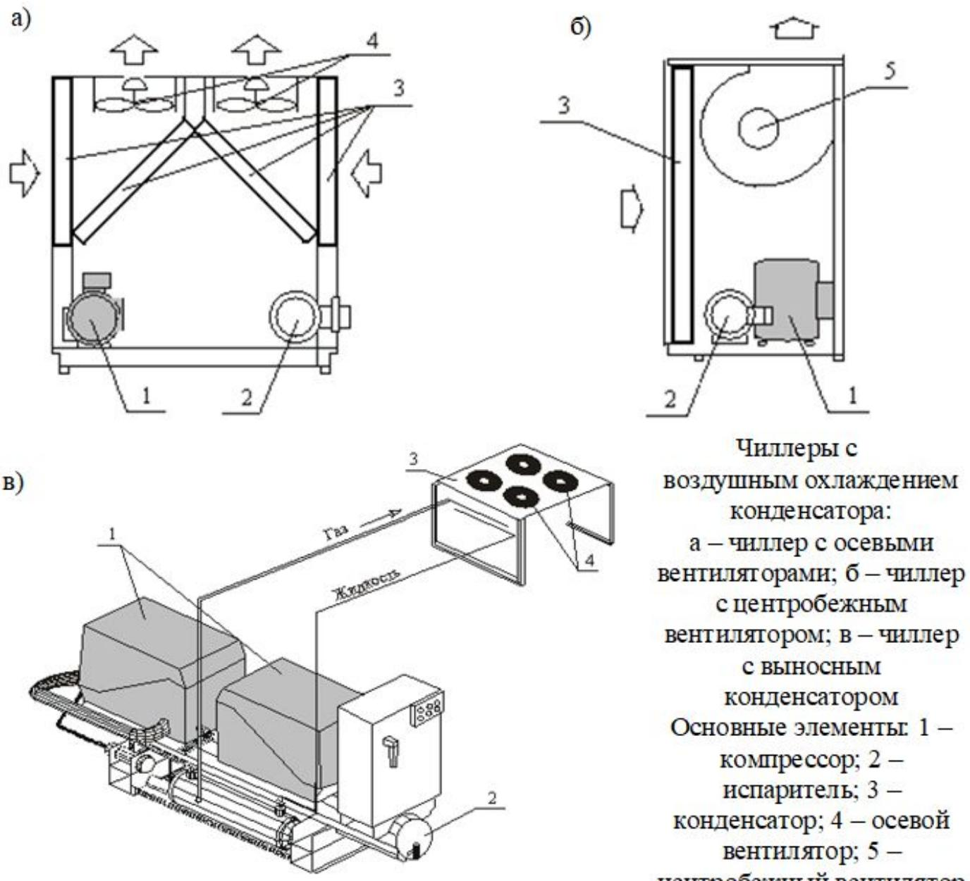
Чиллеры с воздушным охлаждением конденсатора:
