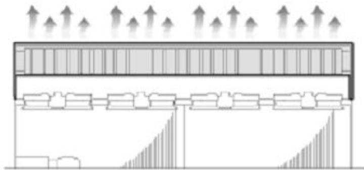
Чиллеры с дополнительным оборудованием для снижения шума:
