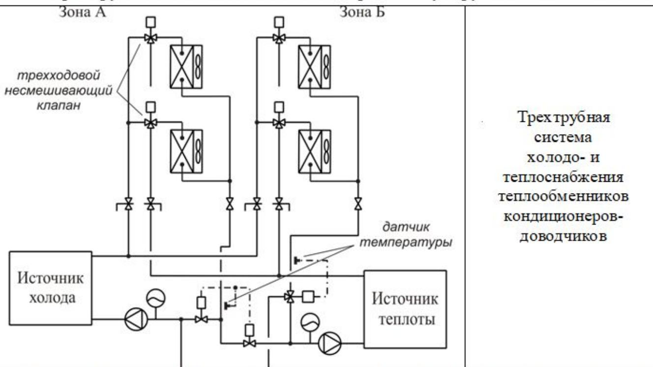
является то, что в обратной трубе при смешивании теряется тепло и холод, повышается нагрузка на чиллер и источник тепла, снижается экономичность.
