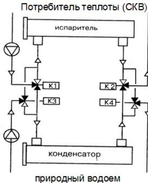
Схема переключения чиллера с водяным охлаждением конденсатора на выработку тепла:
