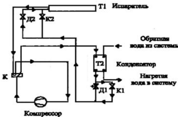
Схема чиллера с функцией ТН:
