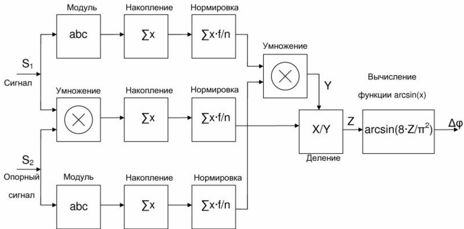
Рис. 2.5. Функциональная схема цифрового фазового детектора
