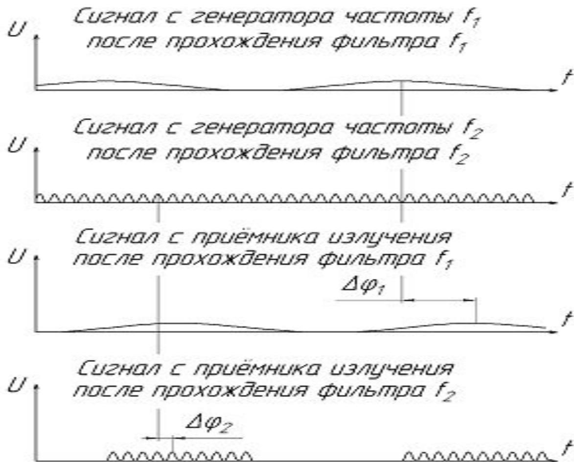
**Рис. 2.4.** Графики сигналов, поясняющие работу лазерного фазового дальномера
