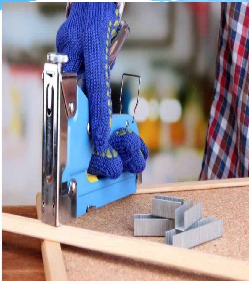
Строительный степлер (иногда его называют гвозде- или скобкозабивателем) — это инструмент для забивания скоб или гвоздей. Существует несколько типов: механические, электрические и пневматические степлеры.
