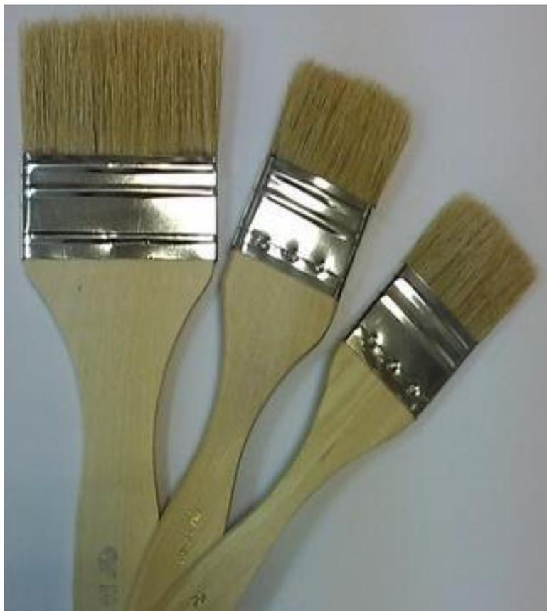
Флейцы применяются для окрашивания поверхностей, удаления следов от ручников и сглаживания. Это плоские кисти шириной 25-100 мм из полухребтовой щетины хорошего качества. Однако самый лучший инструмент для маляров-профессионалов изготавливается из барсучьего волоса в металлической оправе.
