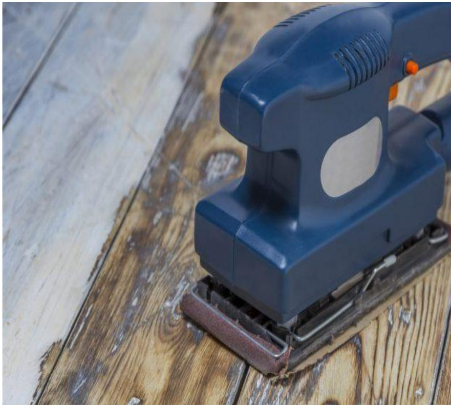
Это инструмент для шлифовки различных поверхностей. Существуют разные типы шлифмашин. Самый простой — вибрационный. Плоская прямоугольная подошва закрепляется на якоре, который передаёт движения от двигателя. Таким инструментом можно и зачистить, и отшлифовать, и отполировать любую поверхность, можно производить как грубую, так и тонкую работу.
