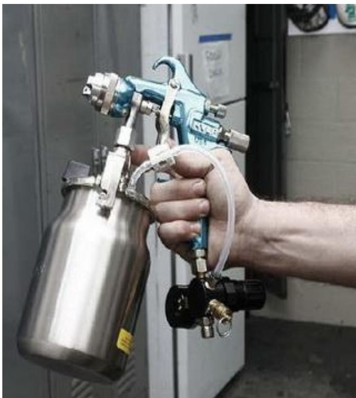
**Пульверизатор** представляет собой емкость для краски, снабженную распылителем. Принцип работы инструмента следующий: частицы краски захватываются потоком воздуха и переносятся на окрашиваемую поверхность. Пульверизатор способен значительно облегчить труд маляра. Ни один ручной инструмент не позволяет наносить краску так быстро, как это делается с помощью пульверизатора. Несравнимо лучше и качество окрашивания — краска ложится равномерно, и поверхность становится гладкой.
