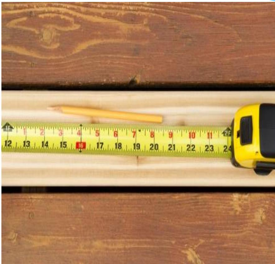
Рулеткой измеряют длину. Обычно она представляет собой металлическую ленту со шкалой, намотанную на катушку в пластиковом корпусе. Внутри — возвратная пружина, помогающая сматывать ленту. Чтобы этого не происходило самопроизвольно, рулетки оснащены стопором. Он фиксирует нужное количество отмотанной ленты. Длина ленты рулетки от 3 до 100 метров.
