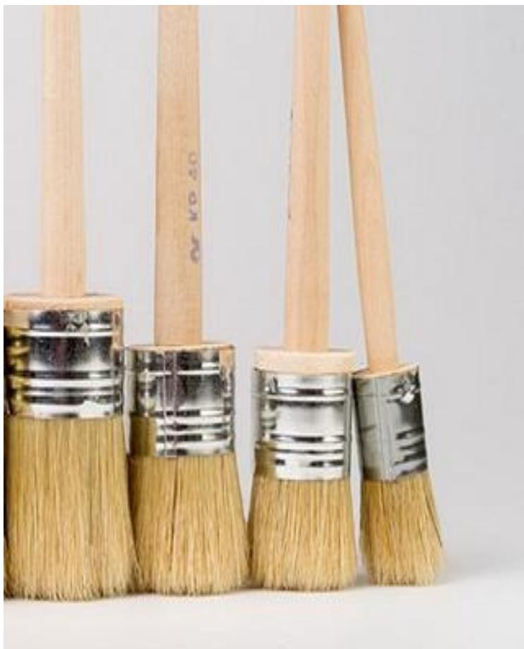
Ручник. Если окрашивания требует небольшая поверхность, с этой задачей легко можно справиться с помощью кисти-ручника диаметром 26-54 мм. Изготавливаются ручники из полухребтовой щетины с добавлением конского волоса средней жесткости (50%), которая может крепиться в деревянной ручке, в металлической оправе или с помощью металлического кольца. Чтобы кисть «брала» максимальное количество краски, в ее внутренней части оставляется пустота.
