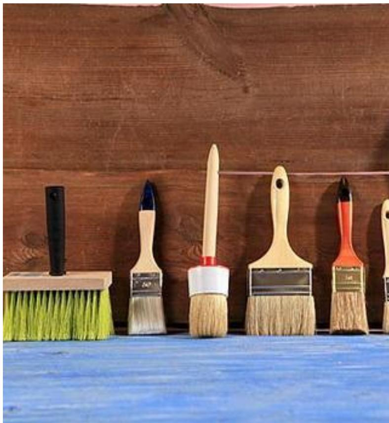
Щетка — это разновидность кисти прямоугольной формы, которая отличается большей рабочей поверхностью. Щетина прикрепляется к инструменту посредством металлической скобы и проклеивается возле основания. Инструмент используется для грунтования и окрашивания ровных поверхностей больших площадей. Щеткой можно заменить краскопульт, когда его применение затруднительно.
