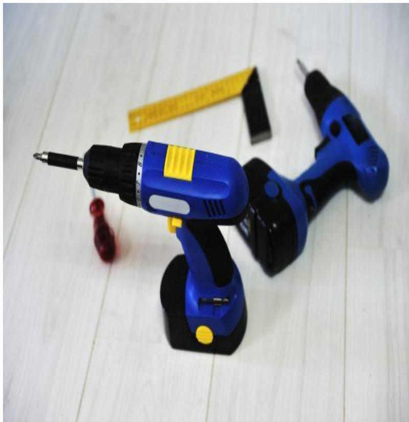
Дрель — это инструмент для сверления отверстий. Это чуть ли не первый инструмент, который приобретает себе мужчина. Дрели бывают ручные, пневматические и электрические. Также есть инструменты, имеющие, помимо сверления, дополнительную функцию. Например, дрель-миксер.
