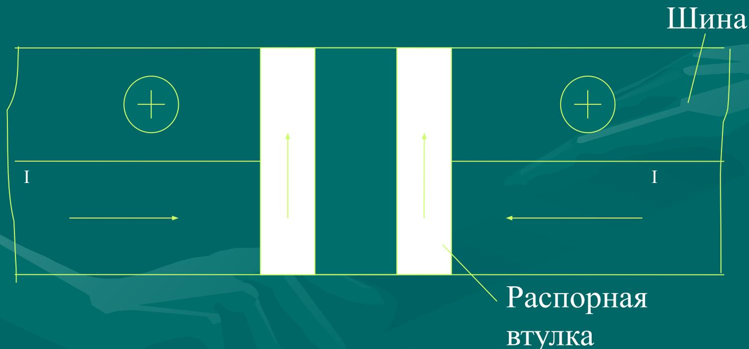
Для пропускания тока 3 кА необходимая площадь сечения вставки  $15 \text{ см}^2$ . При использовании 2х вставок (диаметром 4.4 см) сопротивление узла будет равно 0.7 мкОм.
