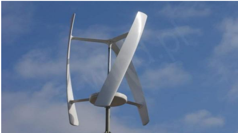
Ветряной генератор с вертикальной осью
