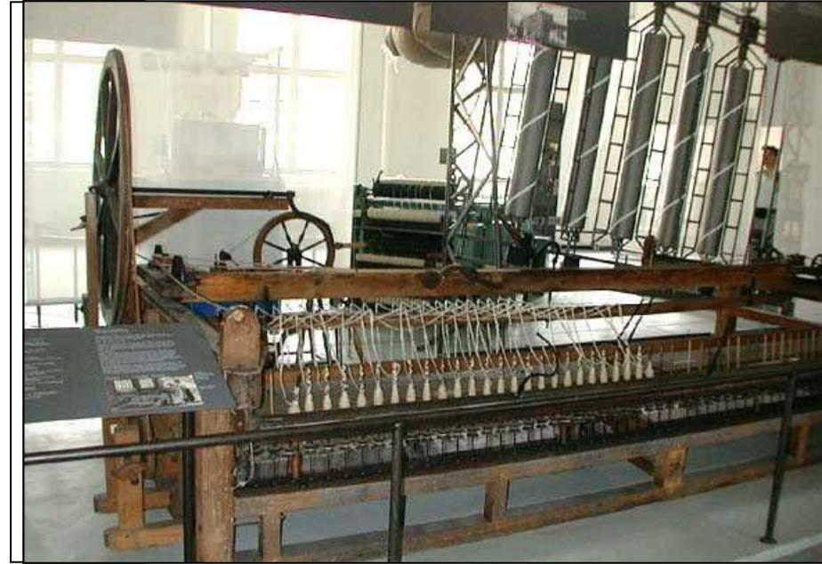
**Рост заморской торговли способствовал развитию мануфактурного производства. В 1765 г. Джеймс Харгривс, борясь с конкуренцией дешевых и качественных индийских тканей соорудил механическую прялку, основанную на одновременной работе 15-18 веретен. Производительность труда выросла в 20 раз.**
