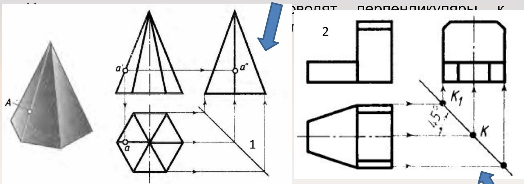
Если три вида уже построены, как на рисунке 2, нужно найти точку, через которую пройдет постоянная прямая. Для этого достаточно продолжить до взаимного пересечения горизонтальную и профильную проекции оси симметрии. Через полученную точку  $K$  проводят прямую под углом  $45^\circ$  к осям.
