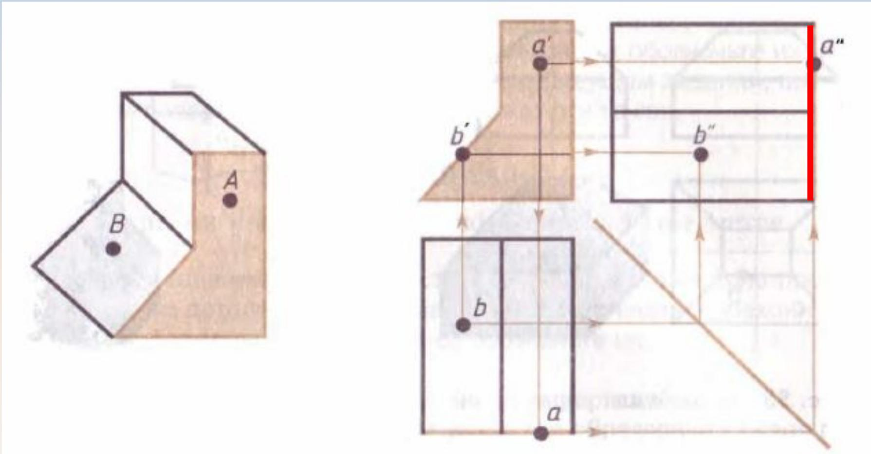
Чтобы найти профильную проекцию, нужно из точки  $a'$  провести горизонтальную линию связи. В месте ее пересечения с отрезком прямой — проекцией грани — лежит точка  $a''$ .
