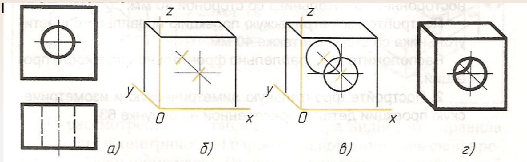
**Изометрической проекцией окружности** является кривая, которая называется *эллипсом*. В черчении применяют упрощенный вариант: овал.
