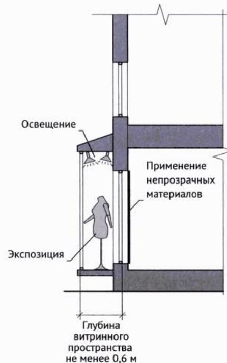
Глубина витринного пространства от первого ряда остекления со стороны улицы (внешней поверхности витрины) до второго ряда остекления со стороны торгового зала (внутренней поверхности витрины) должна быть более 60 см;
