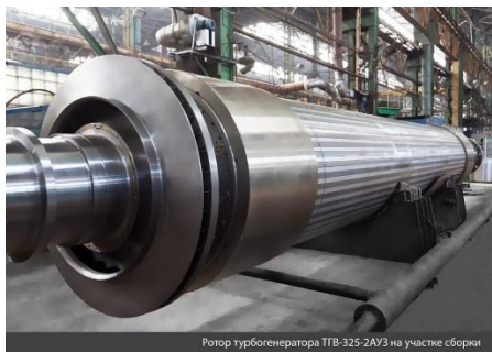
Ротор турбогенератора ТВ-325-2АУ3 на участке сборки
