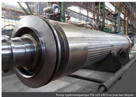
Ротор турбогенератора ТВГ-325-2АУ3 на участке сборки
