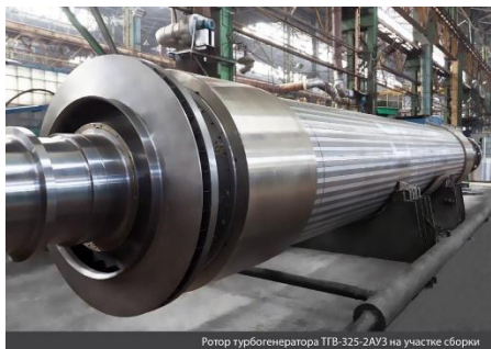
Ротор турбогенератора ТВГ-325-2АУ3 на участке сборки
