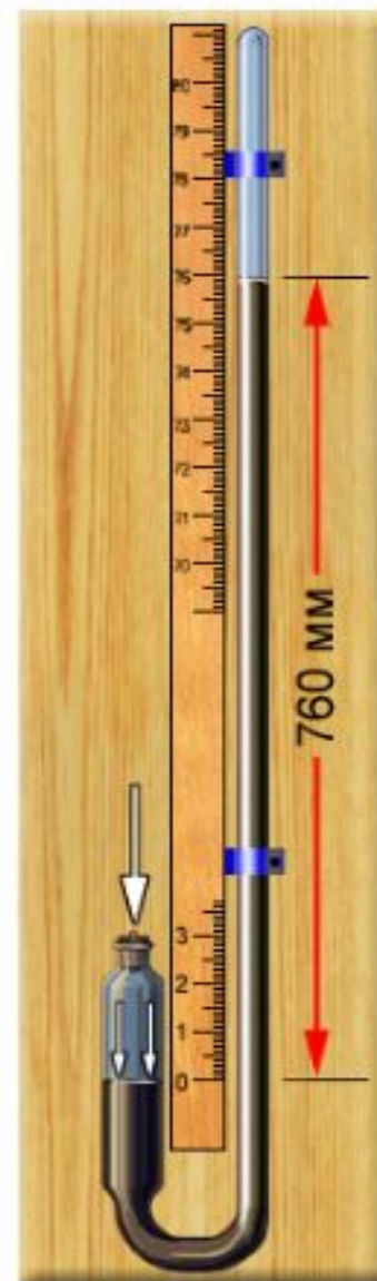
СХЕМАТИЧЕСКОЕ УСТРОЙСТВО РТУТНОГО БАРОМЕТРА
