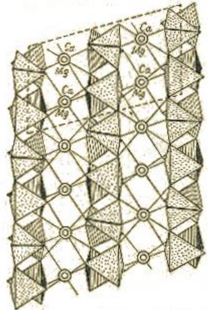
Цепочечный тип структуры (диопсид — \text{CaMg}[\text{Si}_2\text{O}_6] )
