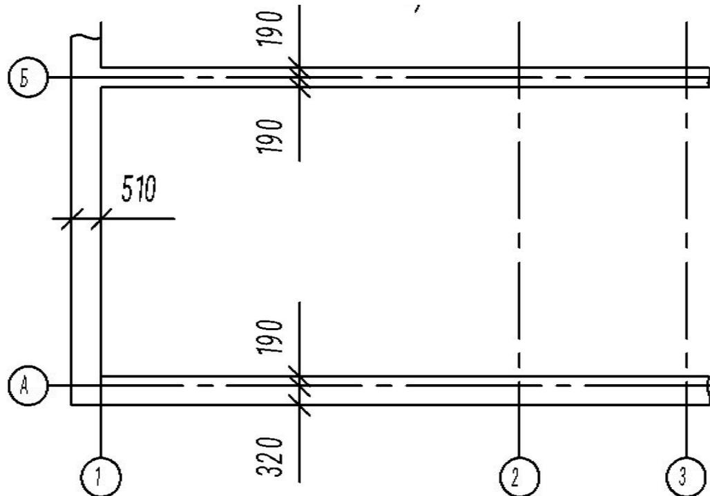
В зданиях с несущими продольными или поперечными стенами привязку к координационным осям наружных и внутренних стен производят следующим образом:
