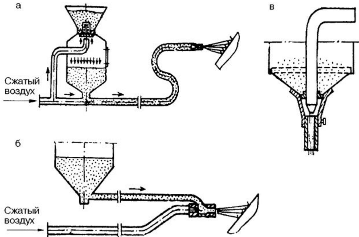
Дробеструйные аппараты нагнетательного (а), всасывающего (б) и гравитационного (в) действия
