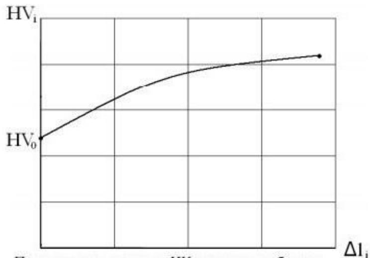
Повышение твердости  $HV$ , материала образца
