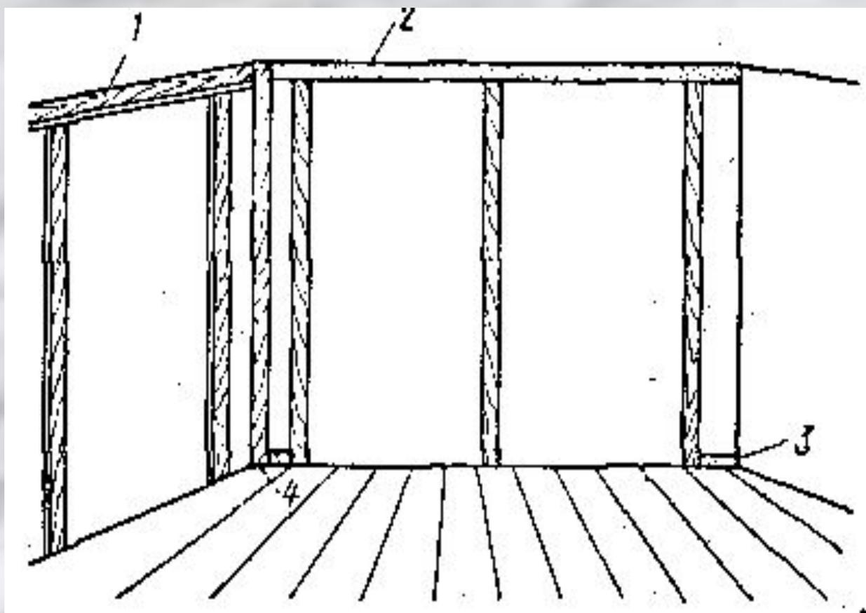
Рис. 50. Устройство лузгов по ранее выполненным маякам:
