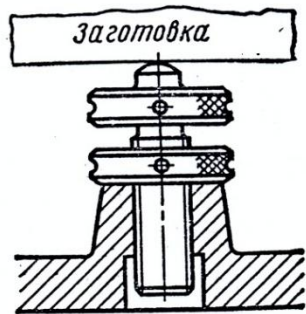
Домкрат резьбовой с накатанной контргайкой
