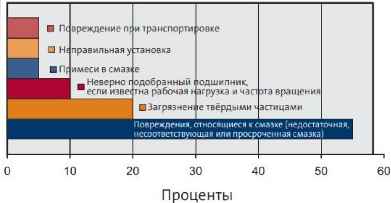
Причины разрушения подшипников качения. Только около 1% подшипников качения полностью отработывают предполагаемый срок службы.
