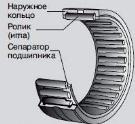
Игольчатый роликоподшипник
