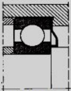
Установка подшипника с упругой металлической уплотнительной шайбой
