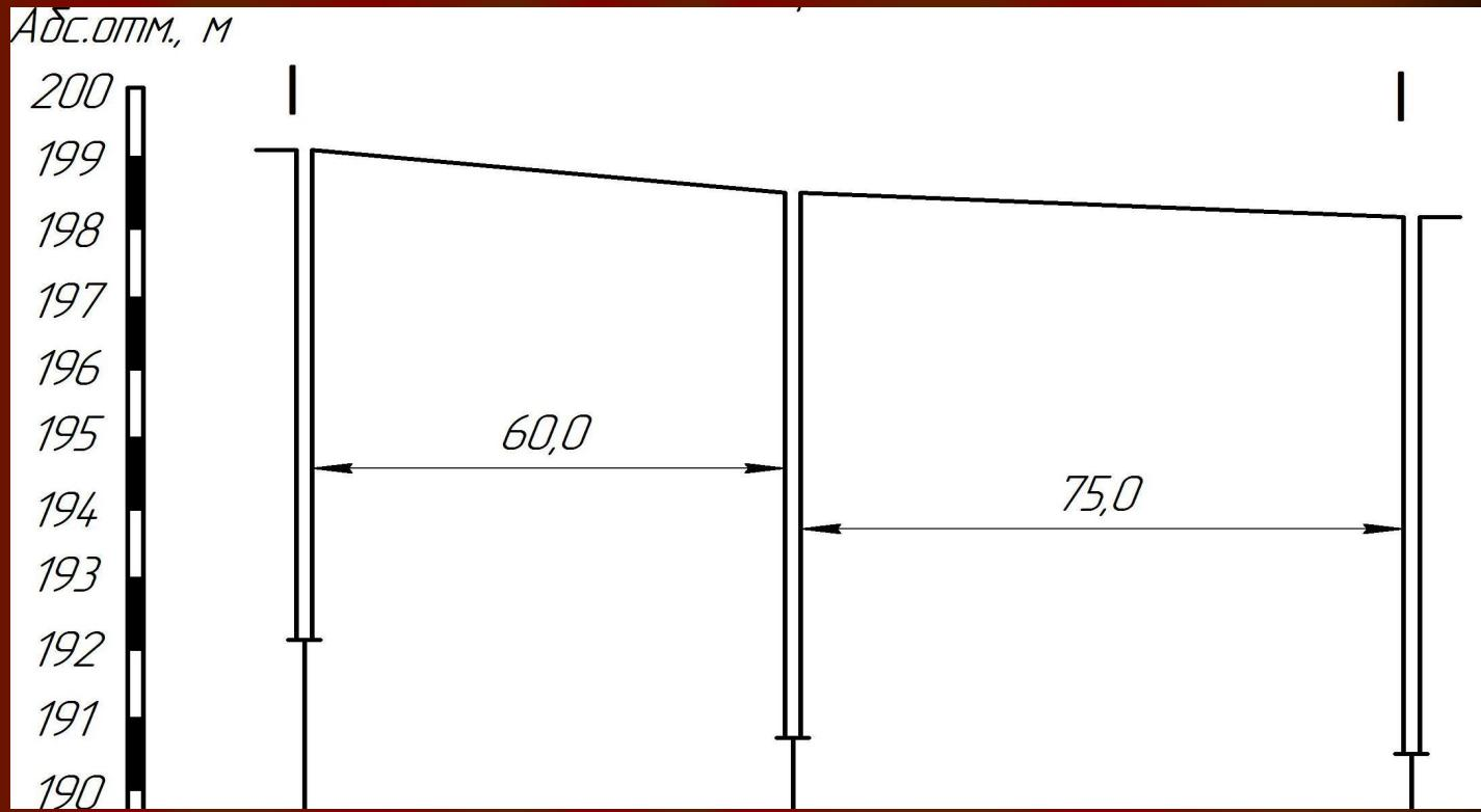
Скважины располагаются друг от друга на расстоянии, указанном в задании. Устья скважин соединяются плавной линией, показывающей рельеф местности. Глубина скважины указана в задании
