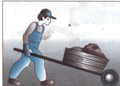
Рычаг второго рода
