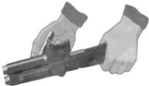
8. Отделить газовую трубку со ствольной накладкой
