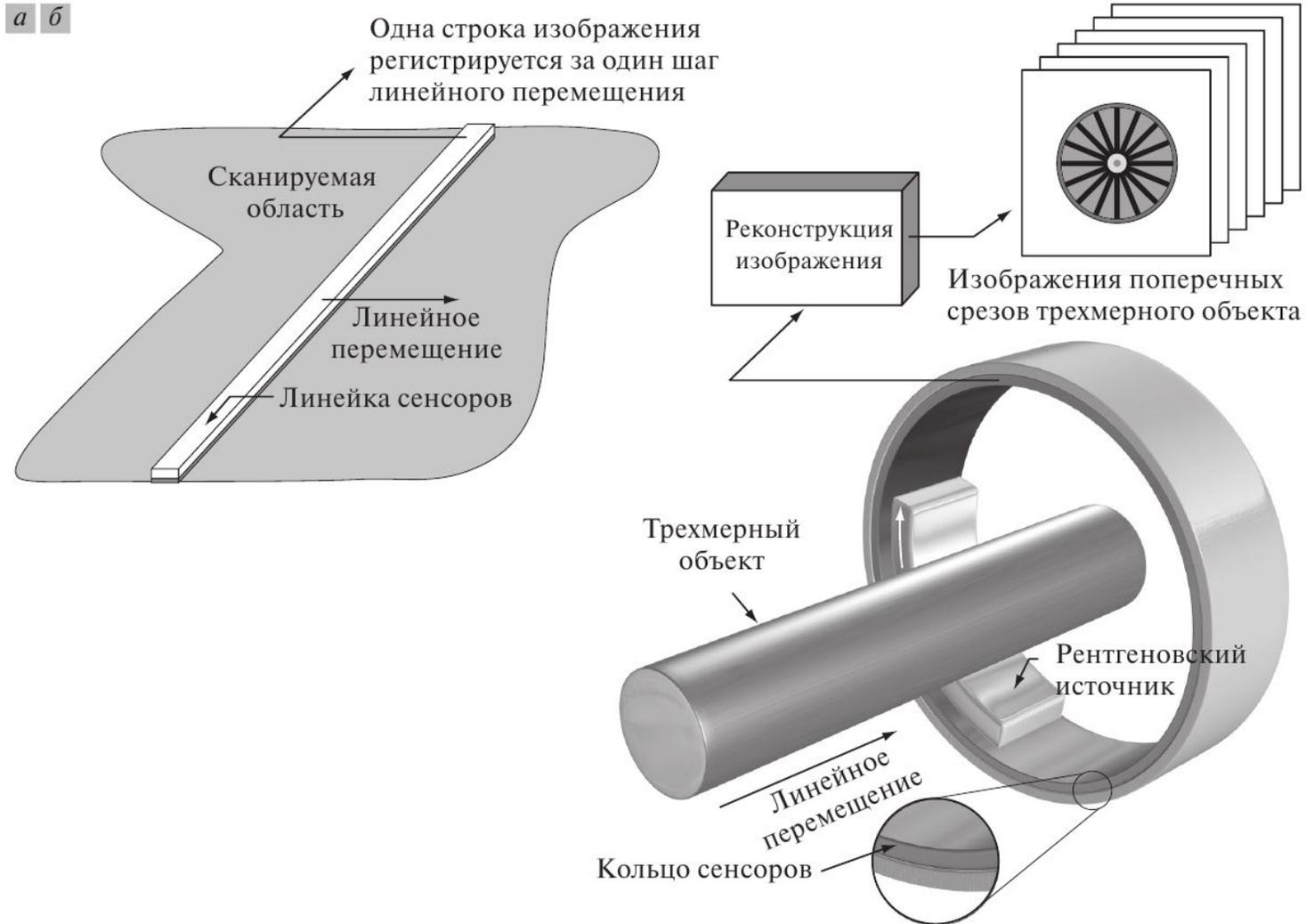
(а) Считывание изображения с помощью линейки сенсоров.
