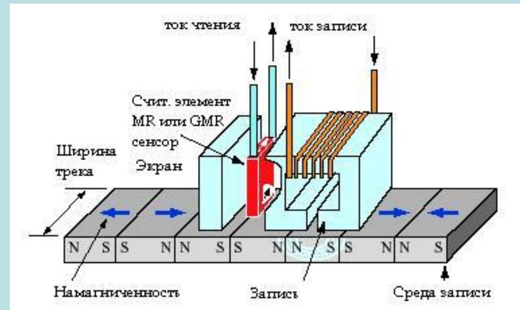
При **считывании** информации при движении магнитной головки над поверхностью носителя намагниченные участки носителя вызывают в ней импульсы тока (явление электромагнитной индукции)
