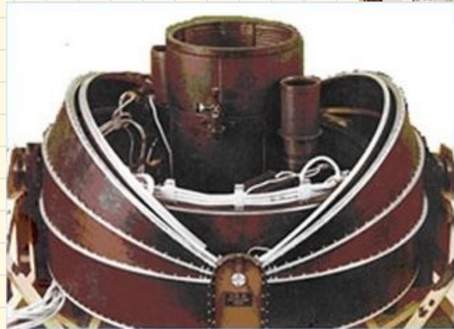
Телескоп ГЛАЗАР-2 с открытым куполом Габариты 1073x1386x1427 Общий вес 310кг.
