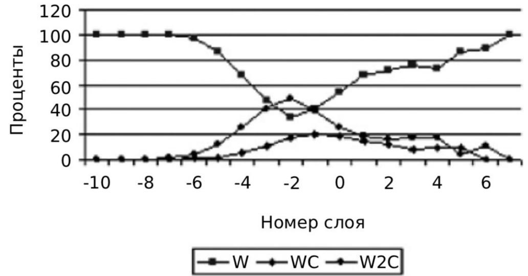
Рис. 2. Распределение веществ в покрытии по слоям
