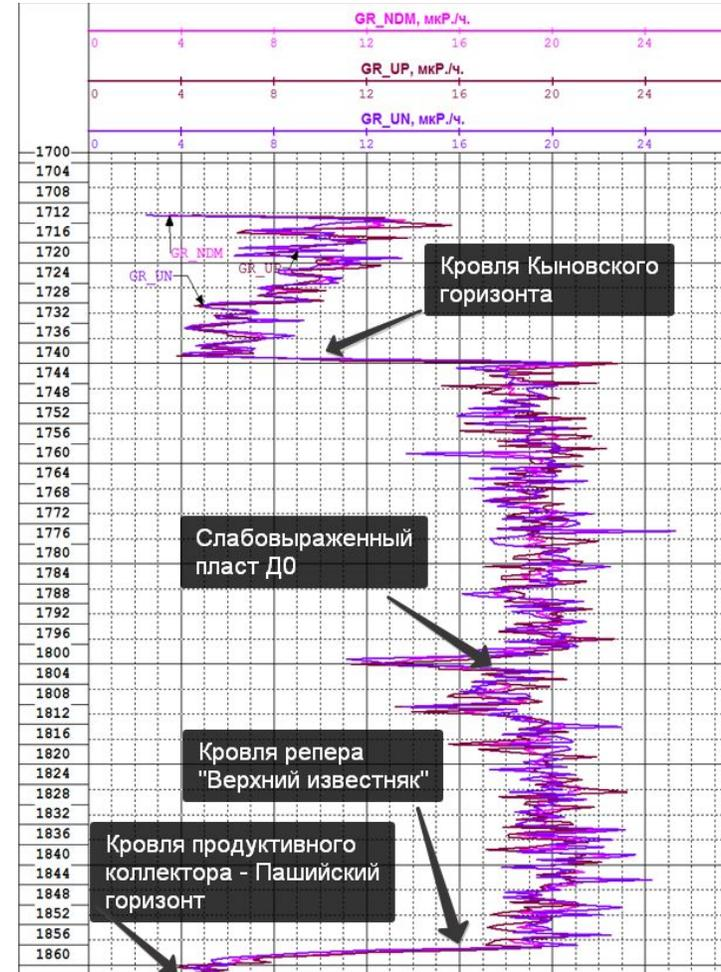
Пример вскрытия продуктивного коллектора с НДМ (D=150 мм) без привязочного каротажа. Бурение большим диаметром. D НУБТ=178 мм, D дотота=215,9 мм.
