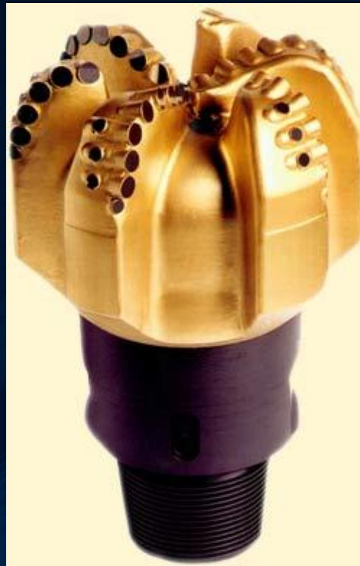
Твёрдые армированные вставки делают в целях увеличения износостойкости долота. Промывочные отверстия в корпусе лопастей - для промывочного раствора. Раствор поднимает шлам по затрубному пространству на поверхность. Отверстия для промывки есть во всех лопастях.
