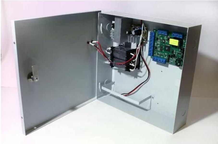
▣ **Контроллер** - устройство, предназначенное для обработки информации со считывателей идентификаторов и принятия решения, пропустить или нет данного пользователя в данную дверь.
