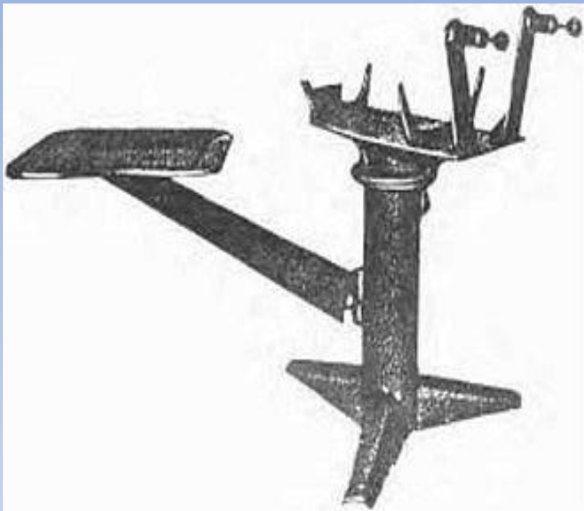
Стенд для ремонта коробки перемены передач
