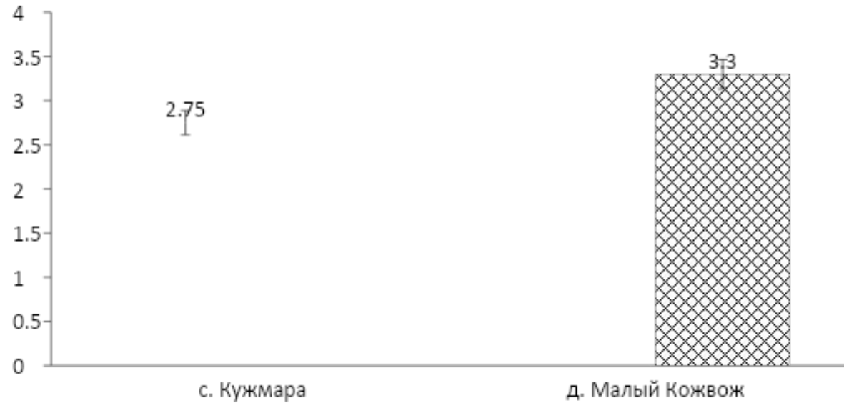
Рис. 2. Жесткость воды из скважин с. Кужмара и д. Малый Кожвож, мг-экв/л. Гигиенический норматив – 7-10 мг-экв/л
