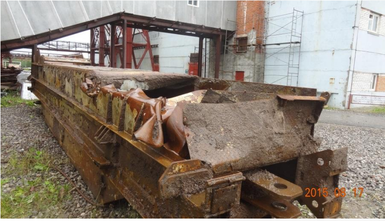
Инцидент, повреждение скипа
