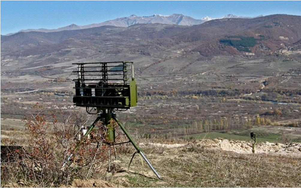
«Гармонь» занимается обеспечением обнаружения и сопровождения самых разнообразных воздушных объектов и целей, определением их государственных принадлежностей, автоматической выдачей трассовых сведений для комплексов автоматизированной системы управления. С этими комплексами были благополучно проведены проверочные испытания в период проведения сочинских Олимпийских игр.
