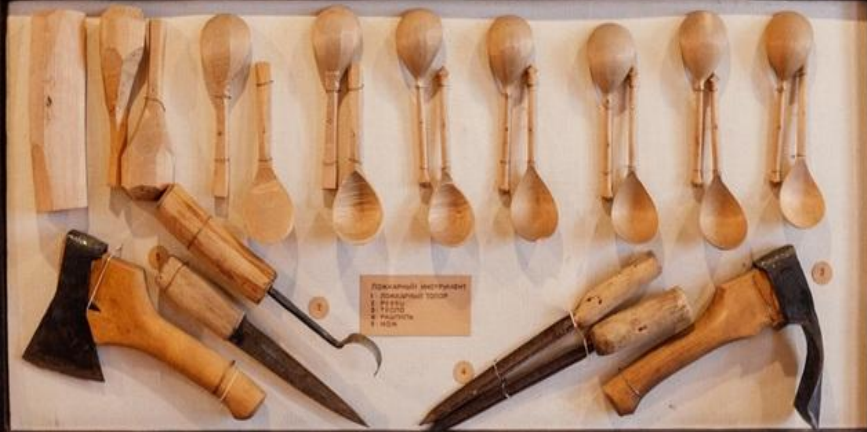
СТАДИИ ИЗГОТОВЛЕНИЯ ЛОЖКИ
