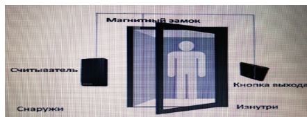
Рис. 2.5 схема работы магнитных замков
