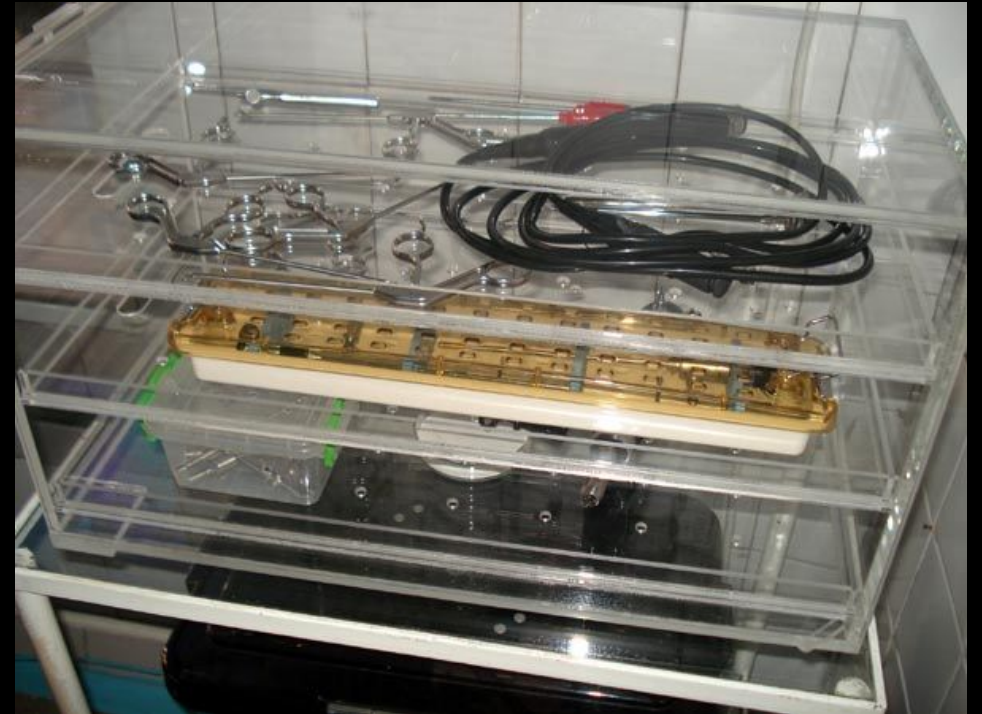
Фото 7. Пароформалиновая камера со стерилизующимися внутри инструментами и расходными материалами. Длительность 12 часов.
