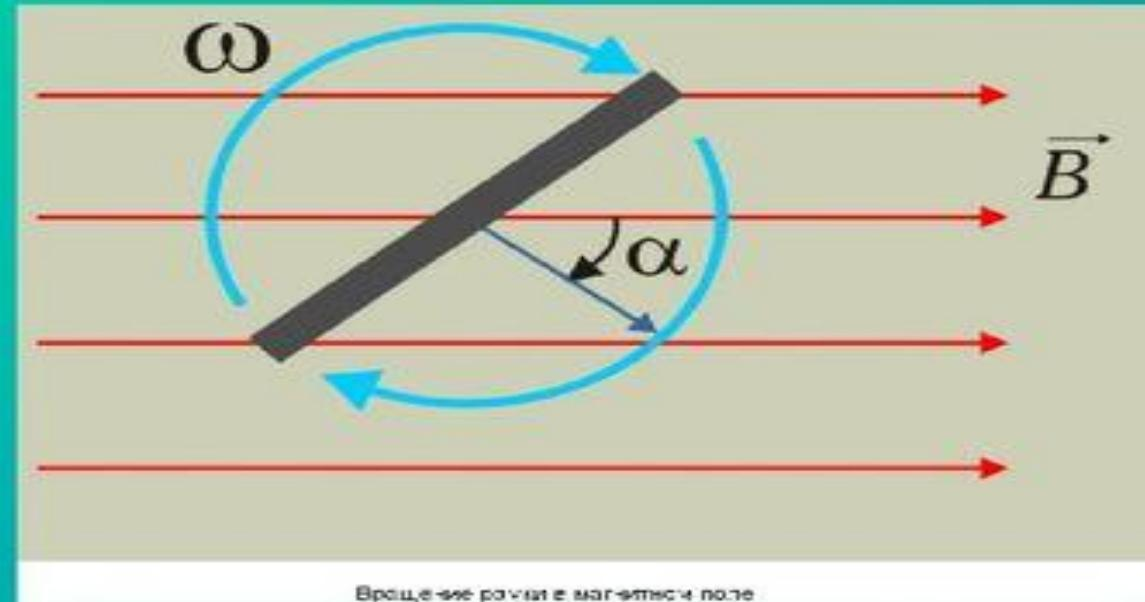
Переменный ток может возникать при наличии в цепи переменной ЭДС. Получение переменной ЭДС в цепи основано на явлении электромагнитной индукции. Для этого токопроводящую рамку равномерно с угловой скоростью вращают в однородном магнитном поле. При этом значение угла между нормалью к рамке и вектором магнитной индукции будет определяться выражением:
