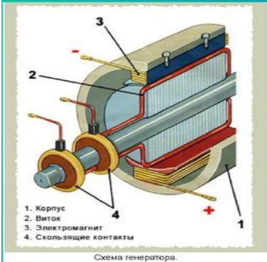
При изменении магнитного потока, пронизывающего контур, ЭДС индукции также изменяется со временем по закону синуса (или косинуса).
