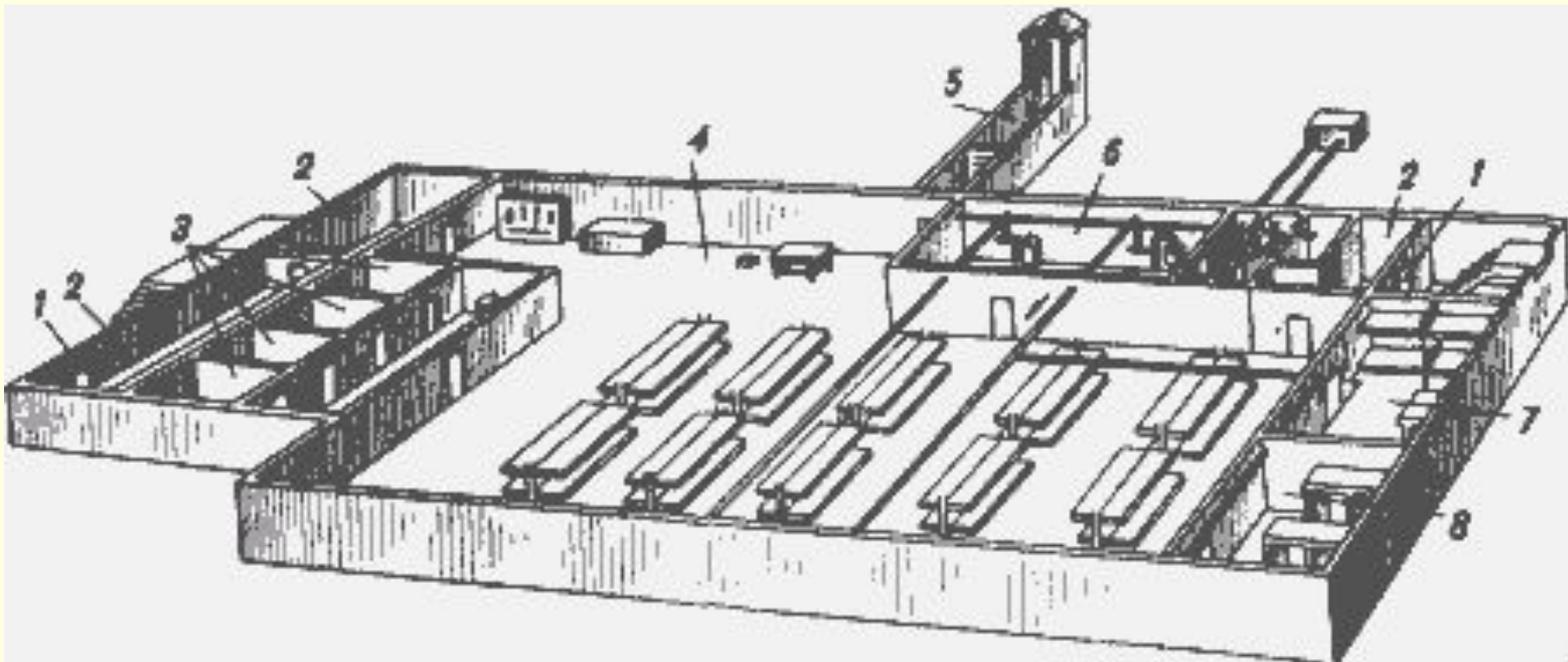
План убежища: 1 — защитно-герметические двери; 2 — шлюзовые камеры (тамбуры); 3 — санитарно-бытовые отсеки; 4 — основное помещение для размещения людей; 5—галерея оголовок аварийного выхода; 6—фильтровентиляционная камера; 7—кладовая для продуктов питания; 8—медицинская комната (помещения 7 и 8 могут не устраиваться)
