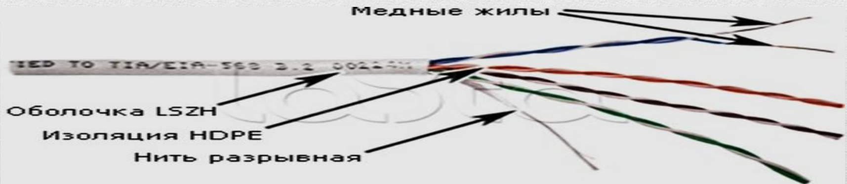
Рисунок 3 (А1) и 4 (А2) – Конструкция кабеля UTP cat5e НГ LSZH 4x2x0,51 CU и UTP cat5e LSZH 25x2x52
