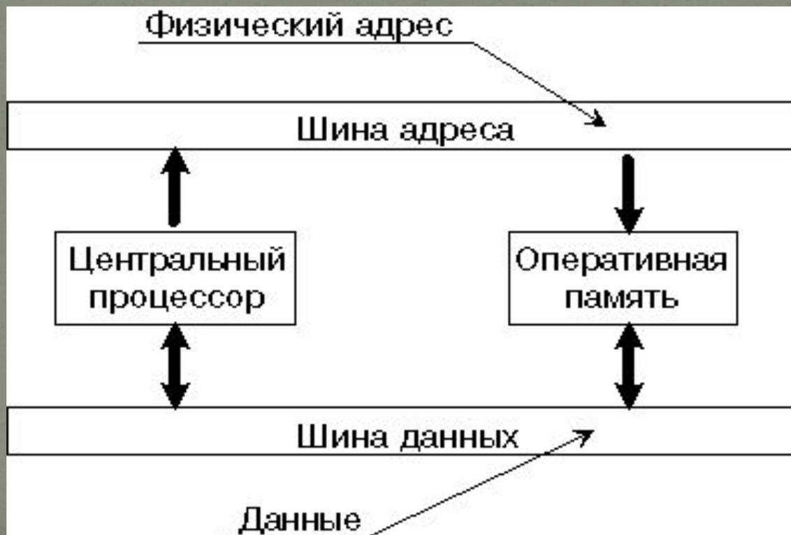
В компьютерах, собранных на базе процессоров Intel Pentium, шина данных 64-разрядная, то есть состоит из 64 линий, по которым за один раз на обработку поступают сразу 8 байтов.
