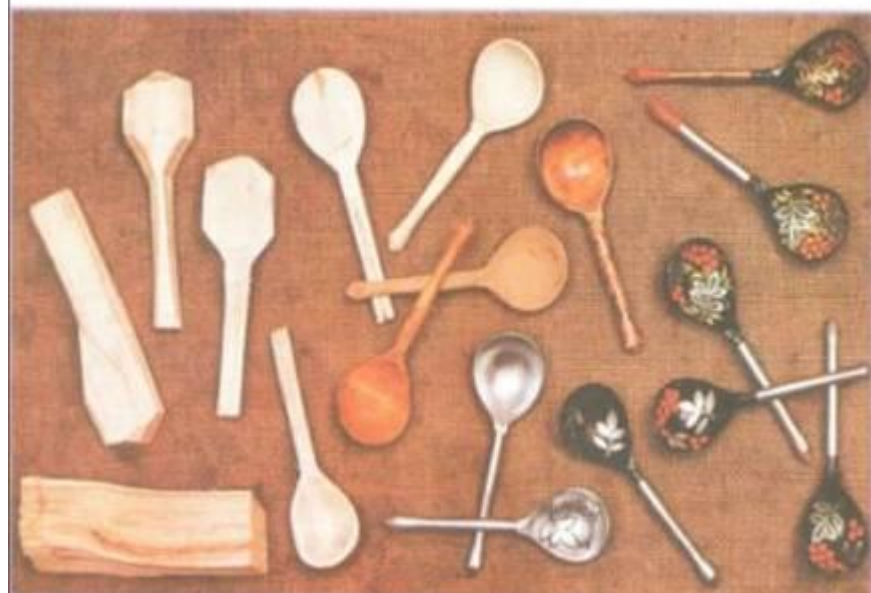
Этапы изготовления ложки: от полена до золотой хохломы
