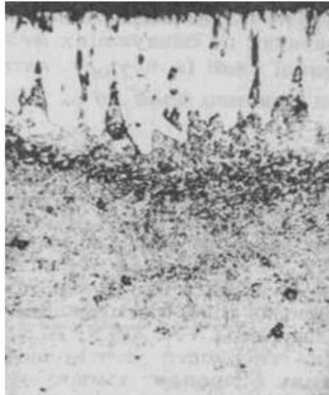
Микроструктура поверхностной области стали, подвергнутой борированию
