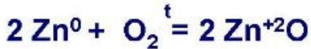
Электрохимическая коррозия металлов отличается от химической тем, что последняя протекает без электротока. А первопричина этих видов коррозии, коей является термодинамическая неустойчивость, остается неизменной. Металлы легко переходят в разные состояния (включая и более устойчивые), причем в этом случае отмечается снижение их термодинамического потенциала.
