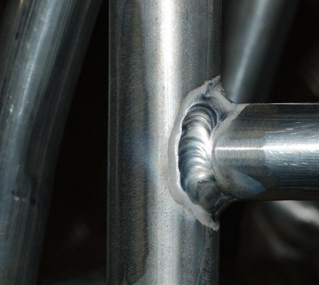
Теплоту, которая необходима для расплавления металла, выделяет электрическая дуга, которая горит между заготовками и электродом.
