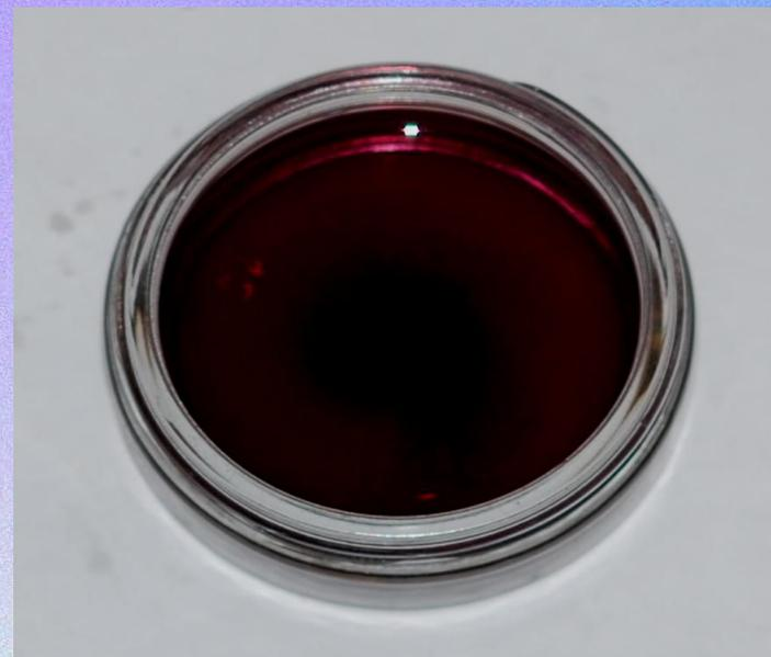
• Анодный процесс:  $\text{Fe}^0 + 8 \text{OH}^- - 6\text{e}^- = \text{FeO}_4^{2-} + 4\text{H}_2\text{O}$
