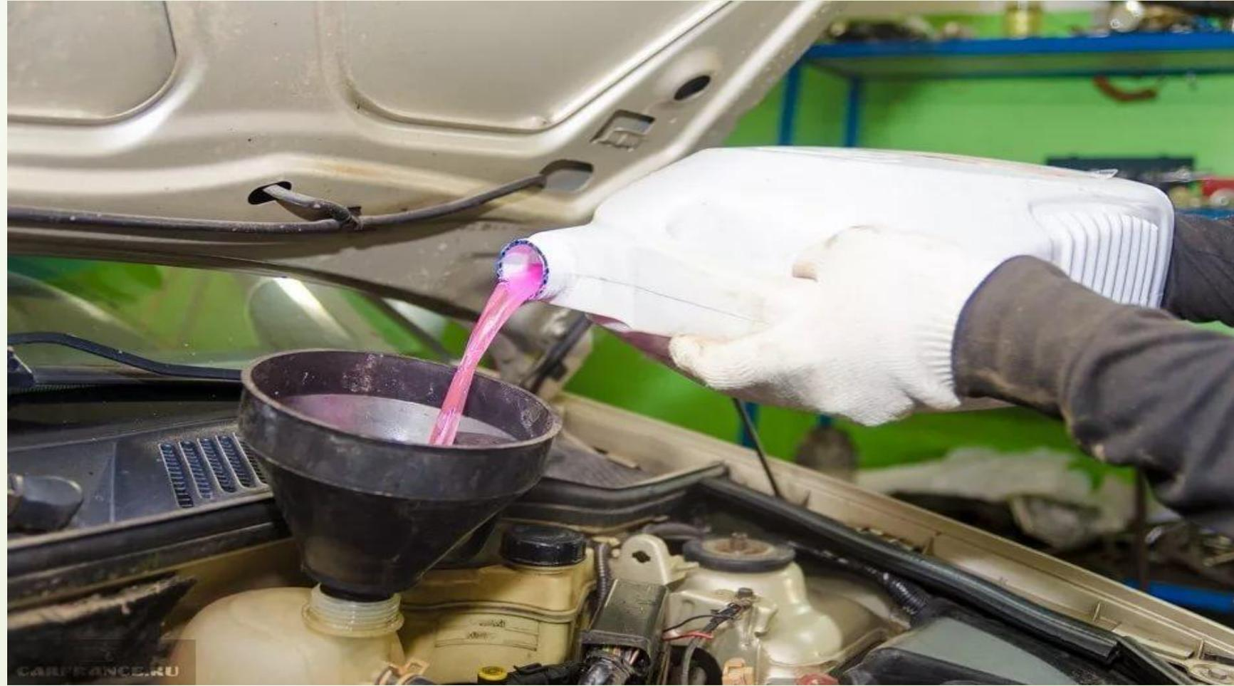
Перед заливкой новой ОЖ, элементы трубопровода проверяют на целостность (трещины и износ). Некоторые резиновые шланги, хомуты и уплотнительные прокладки понадобится заменить.
