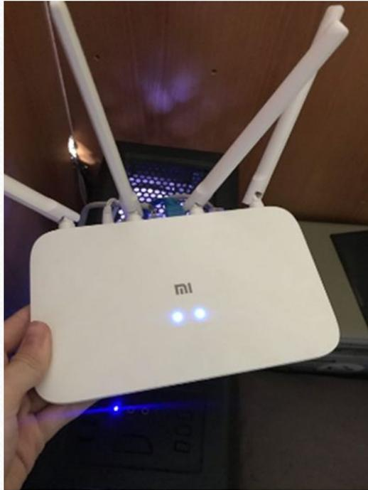
Маршрутизатор Xiaomi Mi Router 4C подходит и для проводной маршрутизации. Модель имеет 2 порта Ethernet. Для управления маршрутизатором используется веб-интерфейс. Устройство получает питание от электрической сети. Блок питания – внешний. Такое конструктивное решение способствует компактности маршрутизатора. Корпус модели имеет традиционный для продукции Xiaomi белый цвет.
