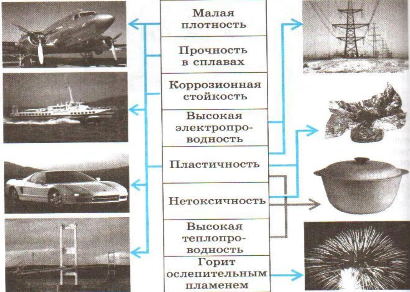
Рис. 31. Основные области применения алюминия и его сплавов
