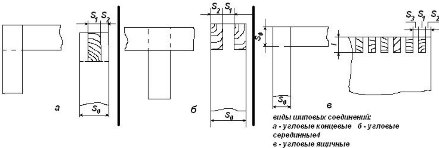
Из клеевых соединений наиболее распространены шиповые. Они подразделяются на угловые концевые, угловые серединные и угловые ящичные. Выбор числа шипов на заготовке зависит от толщины соединяемых деталей. Бруски толщиной до 40 мм чаще всего соединяют одинарным шипом, бруски толщиной свыше 80 мм – тройными многократными.
