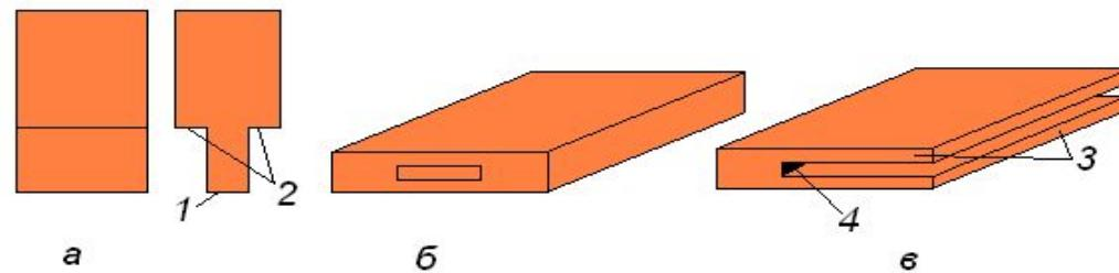
Элементы шипового соединения: а - шип; б - гнездо; в - проушина:
