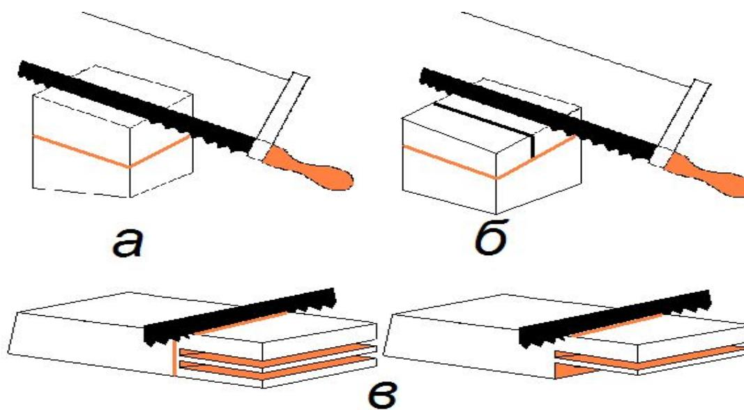
*Запиливание проушин (а) и шипов (б):
