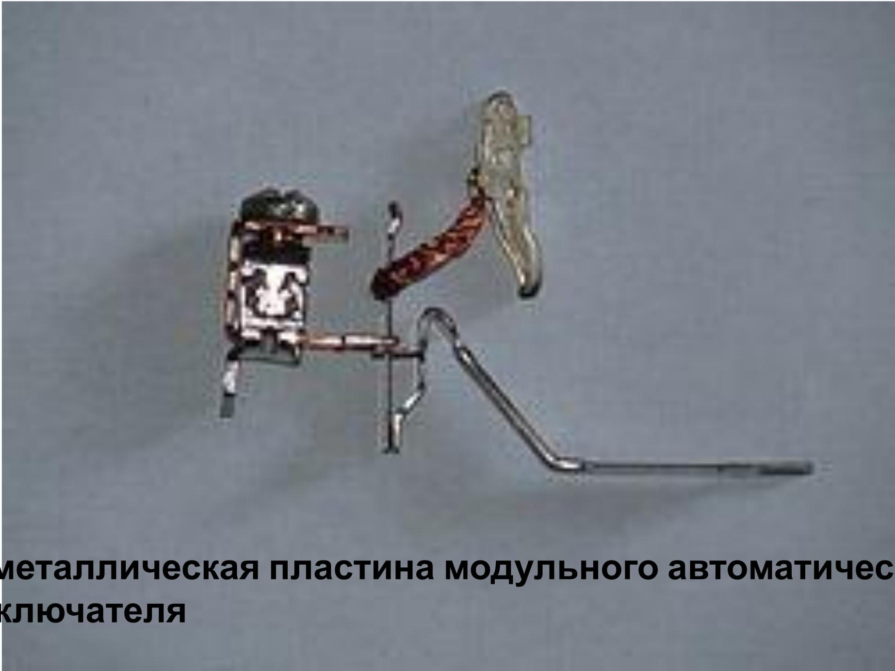
**Биметаллическая пластина модульного автоматического выключателя**
