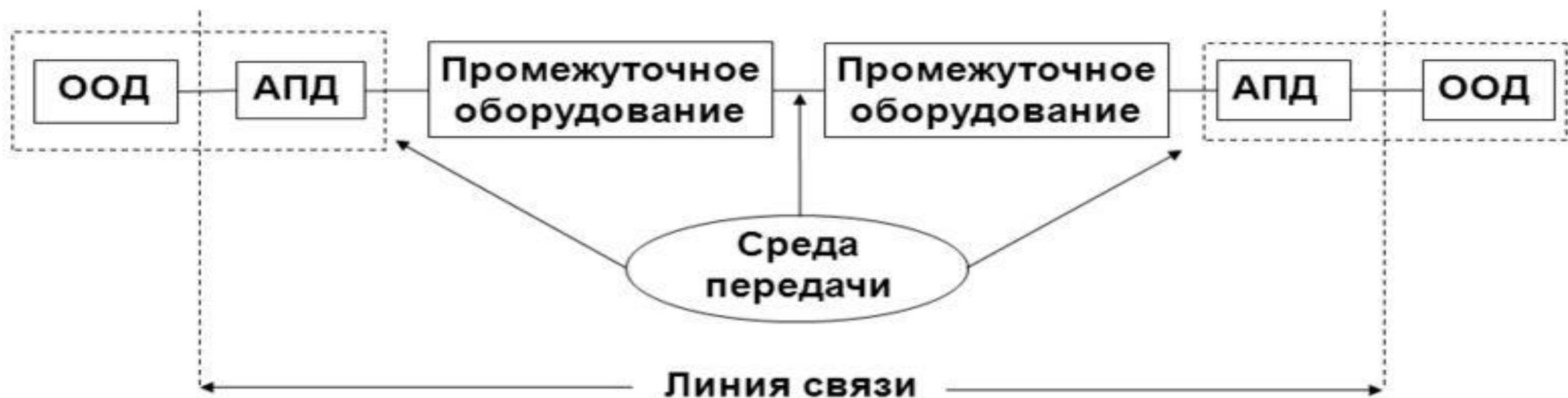
**Оконечное оборудование данных (ООД)** Data Terminal Equipment (DTE) - это устройство или совокупность устройств, способных отправлять и (или) получать данные по сети для решения задач конечного пользователя.
