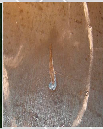
Рисунок 5 - Задиры Дефект поверхности в виде канавки с собранным на конце металлом. Образуется от царапания поверхности металла о детали подъемно - транспортного оборудования. Хаотично расположенные на наружной и на внутренней поверхности трубы. (1020 и 1420)
