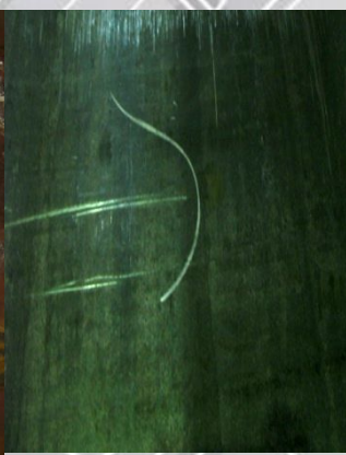
Рисунок 4 - Риски Дефект поверхности в виде канавки без выступа кромок с закругленным или плоским дном. Образуется от царапания поверхности металла о детали подъемно - транспортного оборудования. Поперечные и продольные риски. (1020 и 1420)
