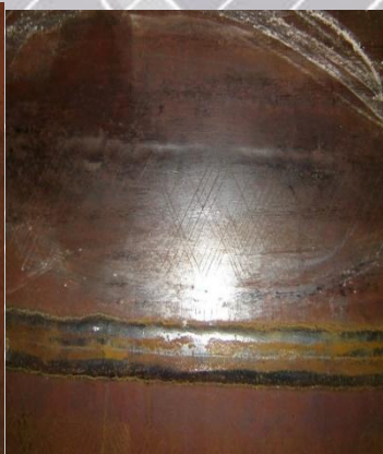
Рисунок 3 - Вмятины Углубление произвольной длины, располагающиеся на наружной или внутренней поверхности листа или трубы. Образуется в результате повреждения или ударов поверхности при транспортировке, складировании и других операциях. Вмятины образуются при неправильной настройке инструмента оборудования. (1020 и 1420)
