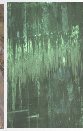
Рисунок 7 - Протиры Нарушение целостности поверхностного слоя листа или трубы с образованием углублений в виде выточки металла цилиндрической формы. Образуется от трения неподвижного проката о вращающиеся детали оборудования. Продольные протиры. (1020 и 1420)
