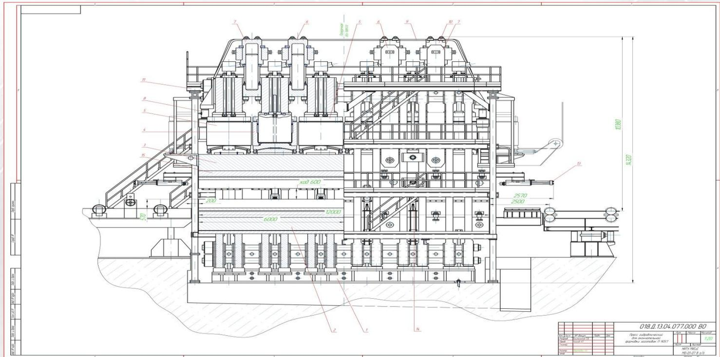
Заготовка U-образной формы по отводящему рольгангу пресса предварительной формовки подается на подъемный рольганг с цепным транспортером пресса окончательной формовки.
