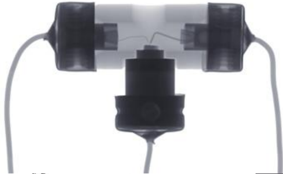
Рис. 1.2. Точечно-контактный p-n переход: 1— полупроводниковая пластина; 2— игла; 3— переход
