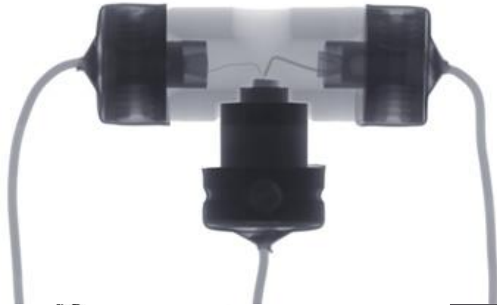
Рис. 1.2. Точечно-контактный p-n переход: 1— полупроводниковая пластина; 2— игла; 3— переход
